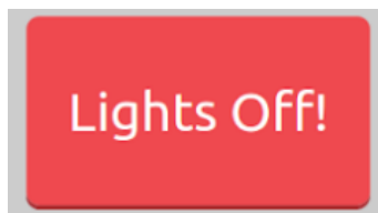
Rysunek 5.8: Przycisk, znajdujący się w prawym górnym rogu aplikacji, wyłączający wszystkie wyjścia cyfrowe
