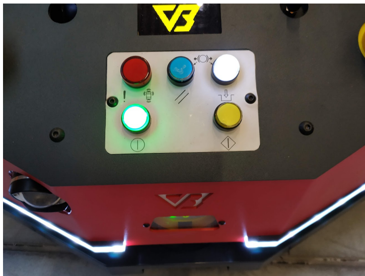
Rysunek 5.11: Panel sterowniczy, informujący o gotowości robota mobilnego
